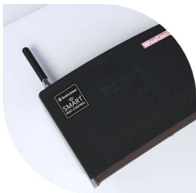
La centralina, Master Box, collega tutte le trappole e i sensori
